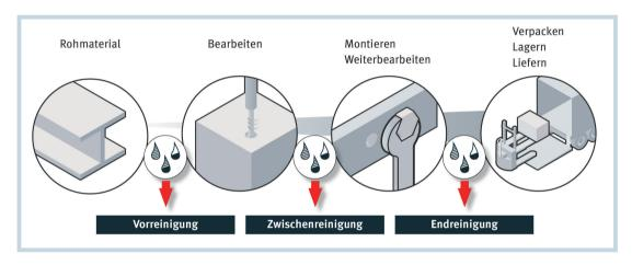
3 Das tatsächliche Reinigen von Werkstücken im Laufe der Projektierung weist nach, dass vorliegende Verunreinigungen prozesssicher entfernt werden (© Pero)
